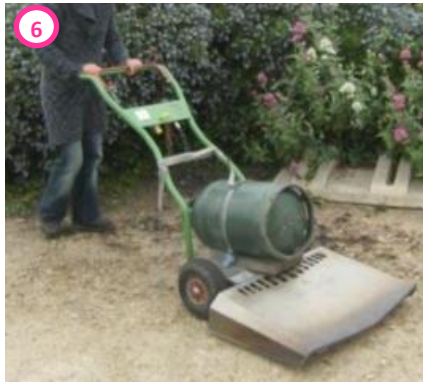
Figure 2 : Exemples de matériels de désherbage à flamme directe et indirecte
